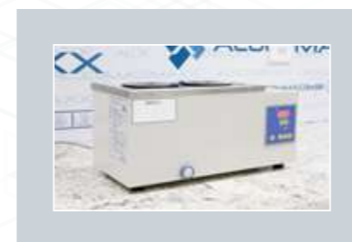
Boiling Water Resistance Simula situações extremas de temperatura para testes de pintura
