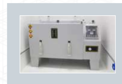
Salt Mist Spray Test (Exposição a névoa salina) Avalia de forma acelerada o desempenho do alumínio e pintura em ambientes extremamente agressivos
