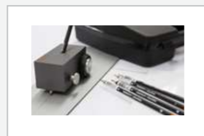
Pencil Hardness Avalia a dureza da pintura pela impressão de grafite
