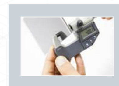
Digital Micrometer Controle da espessura do painel
