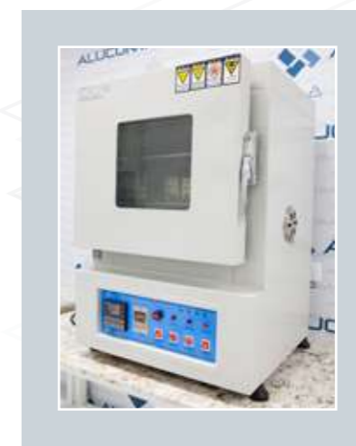
Hood Controla a estabilidade do material ao ser exposto a altas temperaturas
