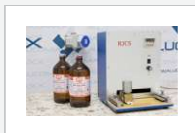
Paint Cure Test Avalia o tipo de pintura ou resina aplicada (PVDF ou poliéster)
