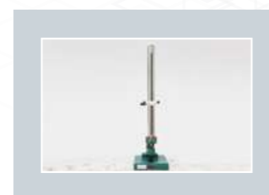
Ball Point Test Avalia a flexibilidade da pintura e dureza do alumínio
