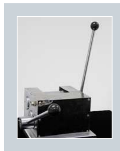
T-Bend Test Avalia a elasticidade da pintura e o alongamento do alumínio
