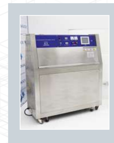
QUV Accelerated Weathering Test Simulação aos raios UV de forma acelerada
